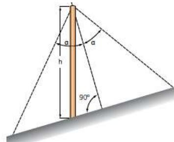
Détermination de l'angle de protection en fonction de la hauteur de la tige du paratonnerre et du niveau de protection.
