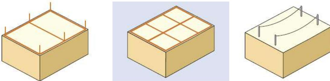
La probabilité de pénétration d'un coup de foudre dans la structure à protéger est considérablement réduite par la présence d'un dispositif de capture convenablement conçu.
